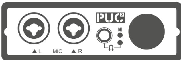
Die Kombibuchsen für die analogen Eingänge erlauben die wahlweise Zuführung von Mikrofon- oder Hochpegelquellen. Sie sind beide symmetrisch ausgeführt.
